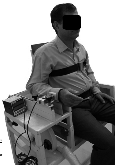
شکل (۲) وضعیت نشستن آزمودنی بر روی صندلی ثبت نیروی ایزومتریک عضلات شانه
