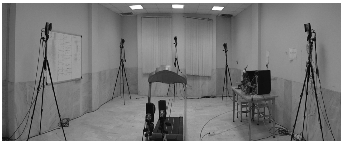
شکل ۱. فضای محل گرفتن آزمون و چگونگی چیدمان دوربین‌ها و تردمیل
